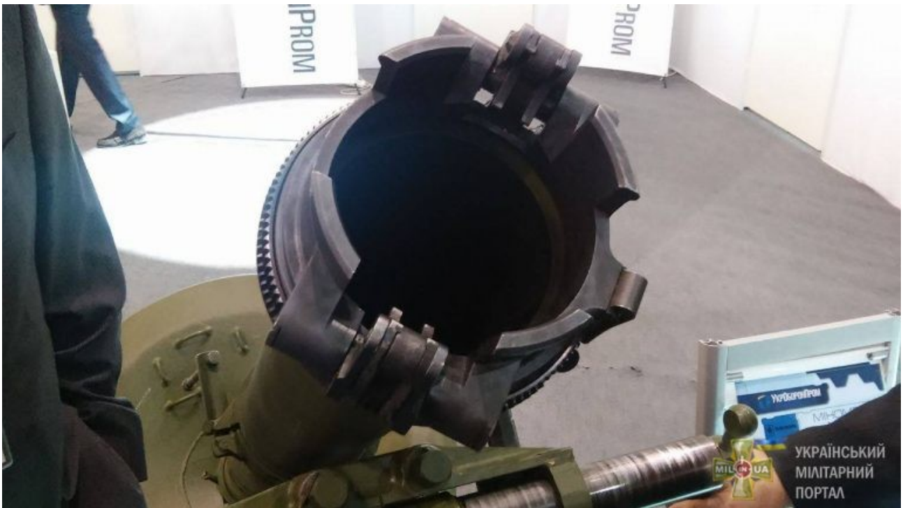
Механізм запобігання подвійного заряджання на мінометі M120-15 «Молот»
